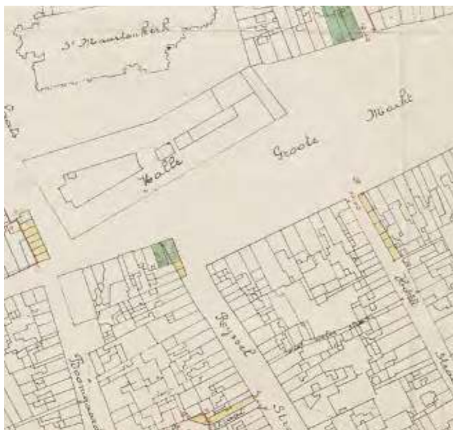
Het wegsnijden van de uitstulping van het bouwblok ten westen van de Rijsselstraat was zowel een rooilijnwijziging om zowel verkeerstechnische als esthetische redenen. De bocht vanuit de Boterstraat was daardoor gemakkelijker te nemen en vanuit de Rijsselstraat kreeg men hierdoor een breder zicht op de Lakenhal. De recente boomaanplant doet hier licht afbreuk aan.
