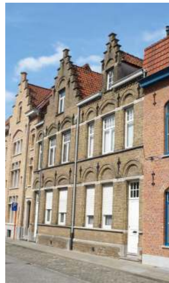
Gevelreeksen getuigen van een doorgedreven efficiëntie zowel voor het ontwerp als voor de bouw: twee variaties in de Bukkerstraat en twee gespiegelde gevels in de De Montstraat. Deze variaties gelden ook voor de planopbouw.
