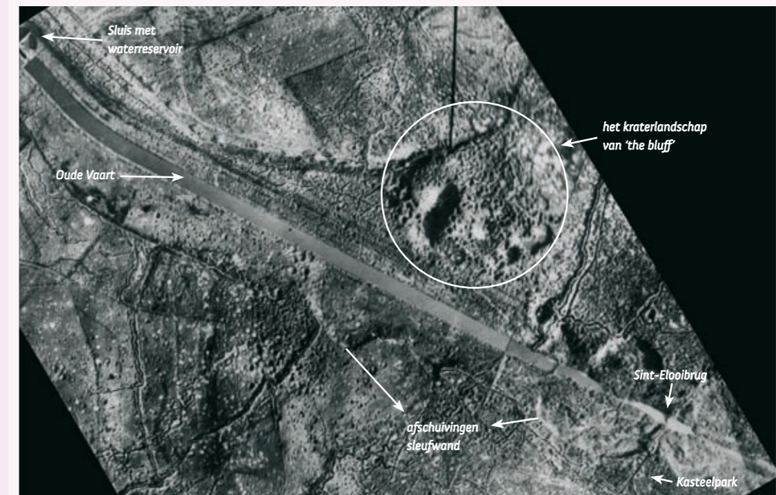
↑ Deze luchtopname van de kanaalsleuf in 1917 illustreert prachtig het dubbele drama van de vaart: de mislukking van de kanaalwerken en de vernietigingen tijdens de oorlog.
